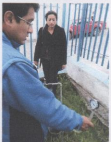
Toma de presiones en los puntos de red
